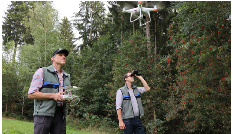
Die beiden LWF-Wissenschaftler Dr. Jan Dempewolf und Phillip Maldoner erheben den Kronenzustand parallel mit Drohnenbildern und okular mit dem Fernglas. Foto: F. Stahl, LWF
