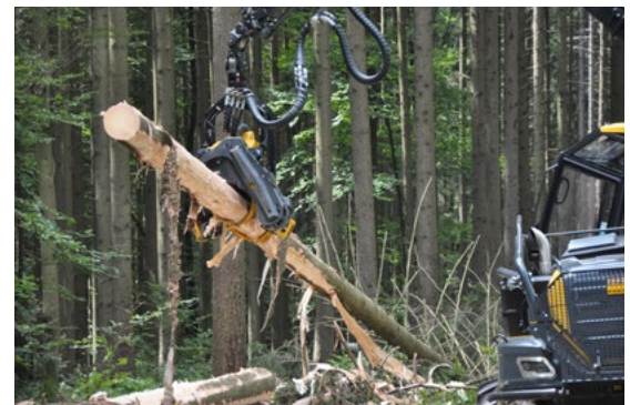
Debarking Head, hier von Ponsse, bei der Entrindung eines Fichtenstammes. Foto: HSWT
