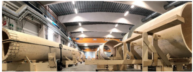
Die Windrad-Türme in Leimschichtbauweise in der Produktionswerkstätte. Foto: Modvion
