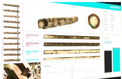
Einschnittoptimierung der Fa. Microtec mittels CT gescannter Stammabschnitte. Foto: M. Knorz, TUM
