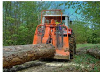
Manuell gefällte Bäume werden durch Forstschlepper mit Seilwinde oder Holzgeräten aus dem Bestand zur Straße gebracht.
