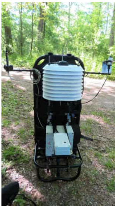
links: der Klimarucksack zeichnet Echtzeitdaten während des Tragens auf
