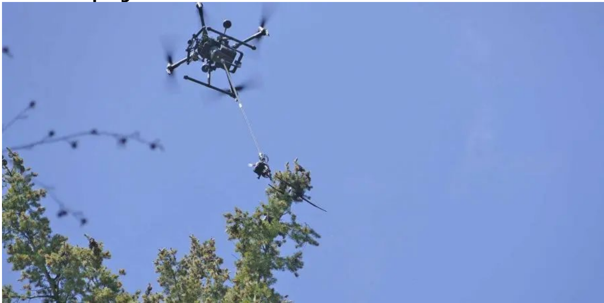
Anfliegen des gewünschten Probeastes und Auslösen der Greif- und Schneidesequenz, Foto: Andreas Müller, AWG.
